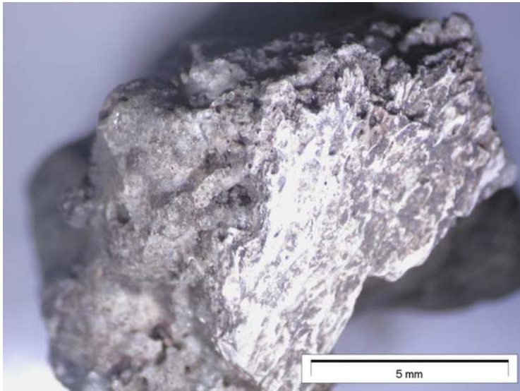
Figur 7. LM 4-5a. Fragment av sammansintrad sand med fastsittande benfragment.
