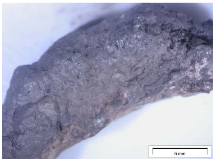
Figur 3. KL 4:5a. Fragment av liten rundad, grund degel (?) med förglasad mynning. Beräknad diameter ca 40 mm.
